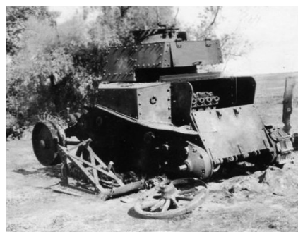
Разукомплектованный танк. Сняты люк, катки, лист двигательного отсека, хвост (лежит рядом). Сохранился двигатель и гусеницы. 1941 год
